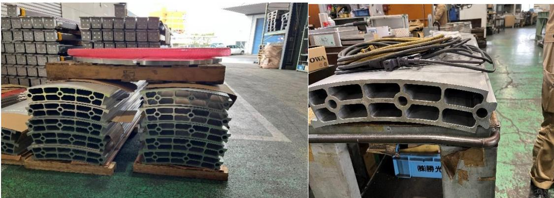
ホーシンの対する本学の解析支援によって、写真に示すようなスモールスケール実験のバイパス管が完成した。本学の解析とホーシンの技術力により高い精度でつくられており、組み上げ時の嵌合にも問題が生じなかった。
